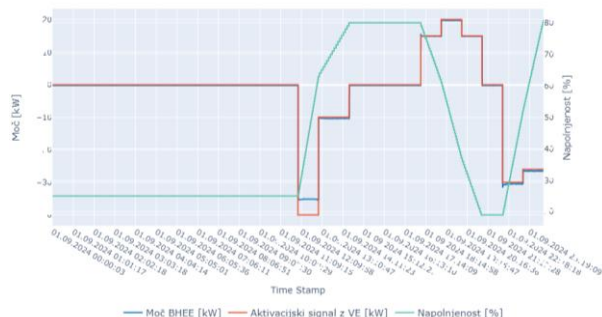
Slika 2: Meritve iz VE in BHEE: Aktivacijski signal iz VE, moč BHEE in napolnjenost v odvisnosti od časa
